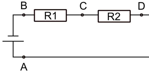
Die Spannungsquelle in der Schaltung erzeugt zwischen ihrem positiven und negativem Anschluss die Potentialdifferenz oder Spannung  $U$ . Die Potentialdifferenz zwischen zwei Punkten  $P$  und  $Q$  soll im folgenden als  $U_{PQ}$  bezeichnet werden.
