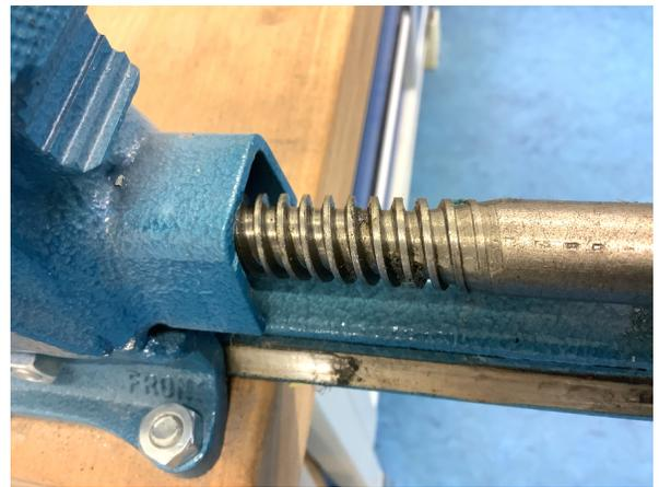
$r$  = Länge des Hebelarms,  $h$  = Ganghöhe des Gewindes
